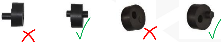
Obrázek 4 – Správné a chybné zasunutí ucpávky do vložky před utáhnutím vývodky
